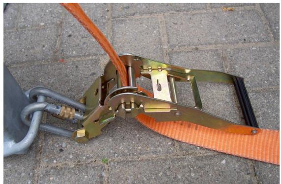
Ist die Slackline gespannt, muss die Ratsche verschlossen werden. Hierfür muss der Hebel in der Mitte gezogen werden und die Ratsche in die links zu sehende Position gebracht werden.
