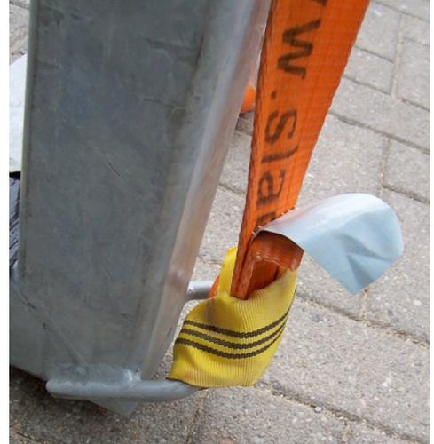
Nun muss das Ende der Slackline durch die obere Durchführung des L-Stücks gezogen werden und zur anderen Seite geführt werden. Auch hier wird die Slackline durch die obere Durchführung geführt. Die Slackline darf an keiner Stelle in sich verdreht sein!!!
