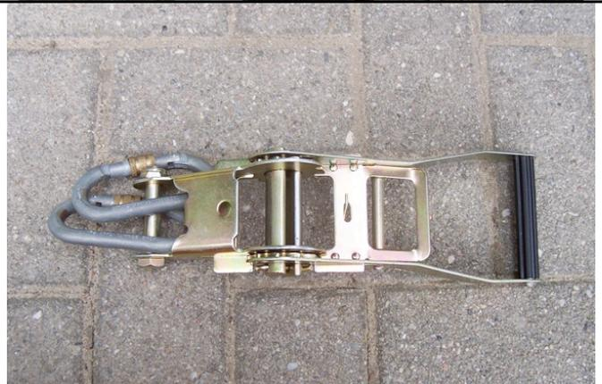
Nun wird die zuvor verlegte Slackline durch die Ratsche geführt. Die Slackline auf Grundspannung bringen und dann beginnen mit der Ratsche zu spannen!!!
